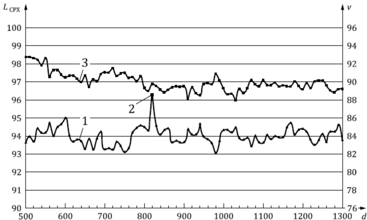
L_{CPX} – уровень звука, дБ; v – скорость, км/ч; d – расстояние, м; 1 – запись L_{CPX:P1,90} ; 2 – исключаемый сегмент; 3 – скорость движения транспортного средства
