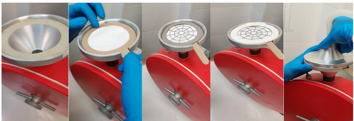
Рисунок 10. Схема сборки фильтродержателя (аллонжа) с фильтром АФА 40
