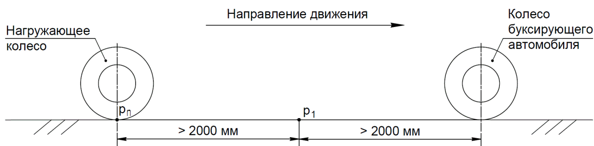
Рисунок 1 – Схема расположения точек фиксации для определения упругого прогиба ДО
